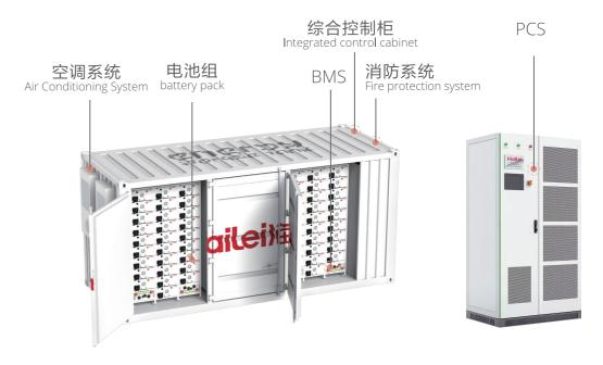
多串电池模组串联通过高压控制箱汇流至综合控制柜内,综合控制柜输出整体直流电路与 PCS 连接,再通过 PCS 与电网并网.
